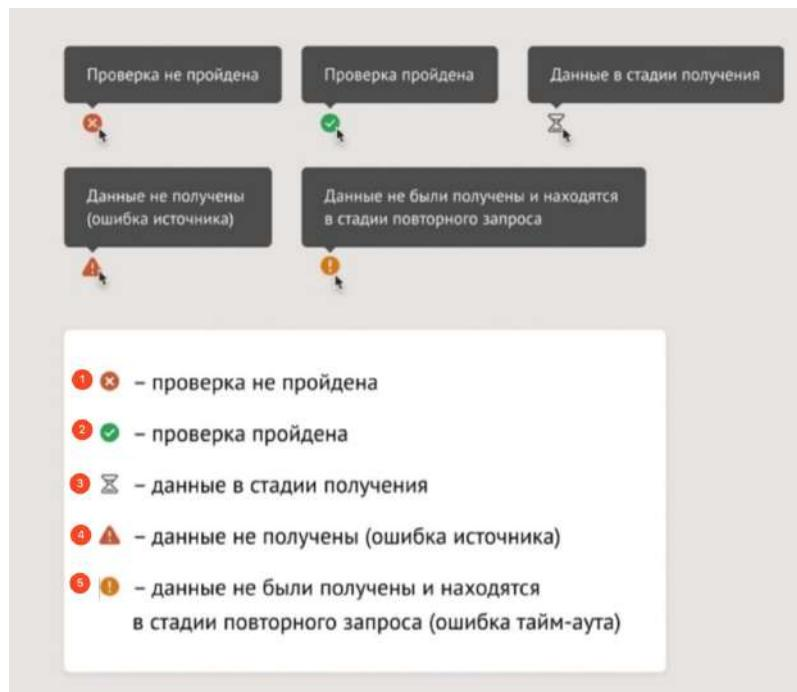
Рисунок 20. Пиктограммы статуса после прохождения автоматической проверки
