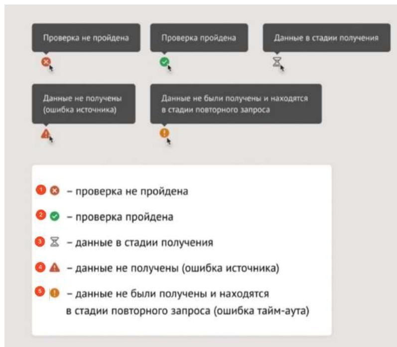
Рисунок 42. Пиктограммы статуса после прохождения автоматической проверки
